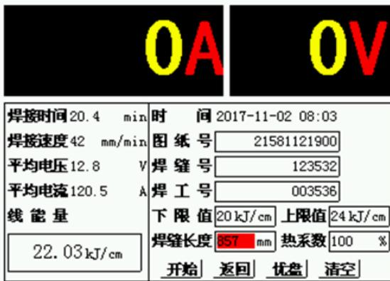
图4 焊接热输入界面
