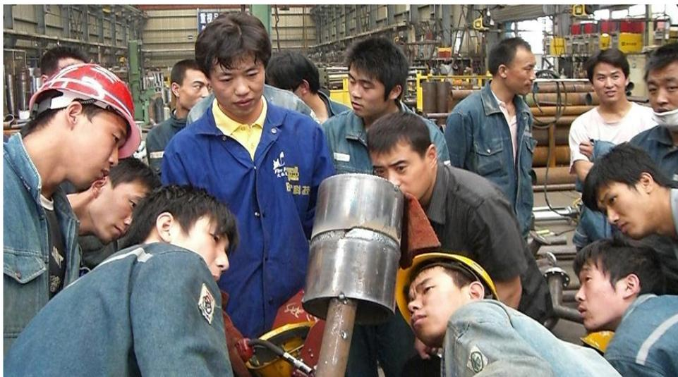
由于焊缝是环形的，在焊接过程中需经过仰焊、立焊、平焊等几种位置，因此焊条角度变化较大，应注意每个位置的操作要领。操作时一般从仰焊部位起焊，按“仰—仰立—立—立平—平焊”的顺序分两个半圆焊接，先焊的一半叫前半部，后焊的一半叫后半部。
