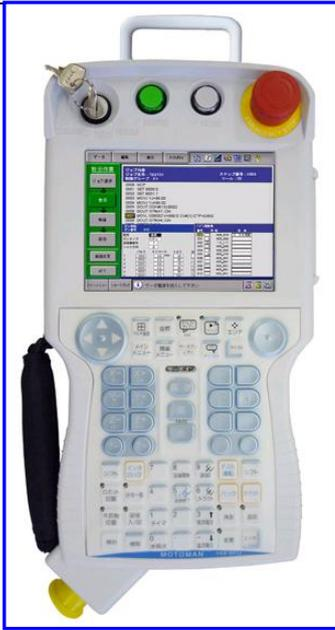
机器人示教编程器如右图所示，它是机器人人机互动的主要界面，集成了通用工业控制按键和按钮，同时按照人机工程学最优化原则配置各类操作按钮并控制编制输入格式。除了密码控制操作权限之外，还有硬件锁。嵌入式 WIN7 系统，支持多任务，多窗口，使编程和监视可以交互操作，有效的提高了编程效率。彩色触摸显示屏。中英日三种可选语言。INFORM III 程序语言，使用集成式命令，可以定制宏命令。
