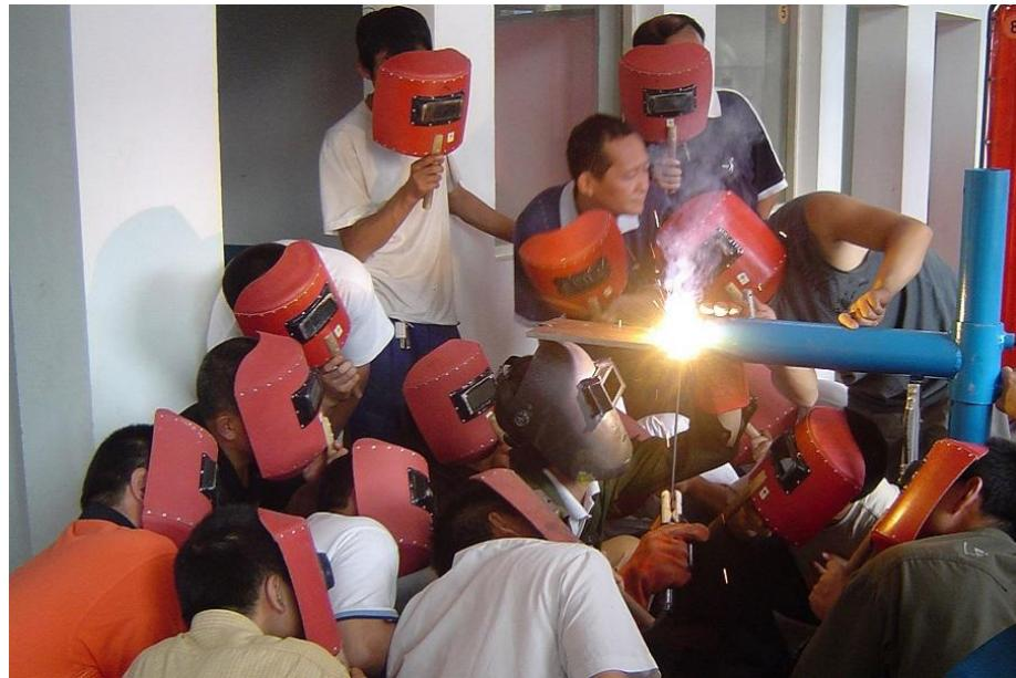
单面焊双面成形操作技术是采用普通焊条，以特殊的操作方法，在坡口的正面进行焊接，焊后保证坡口正反两面都能得到双面成形焊缝的一种操作方法。它是一项在压力管道和锅炉压力容器焊接中，焊工必须掌握的操作技术，其方法主要有断弧焊法和连弧焊法。
