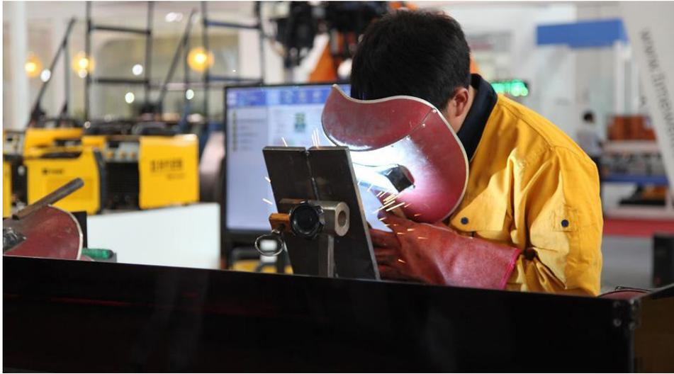
气保焊机有别于其它焊机之处在于它是机、电、气三位一体的设备，在使用过程中，对于其所发生的问题应从三个因素去理解、分析和解决。一般来说，不能焊为电路故障，不好焊为机械故障，焊不好为工艺问题或保护气气体不纯、气路问题等其它原因。这是经验的写照，而后两者占了问题总数的 90%。
